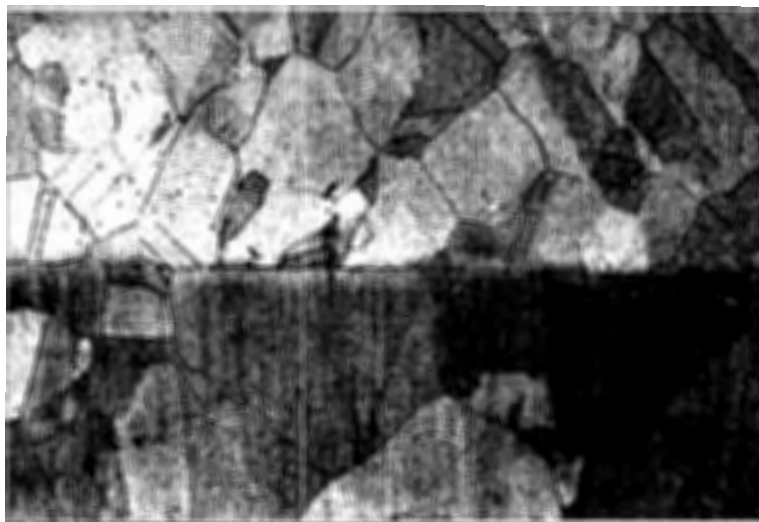
Рис.2. Микроструктура зоны соединения меди (x 200)
